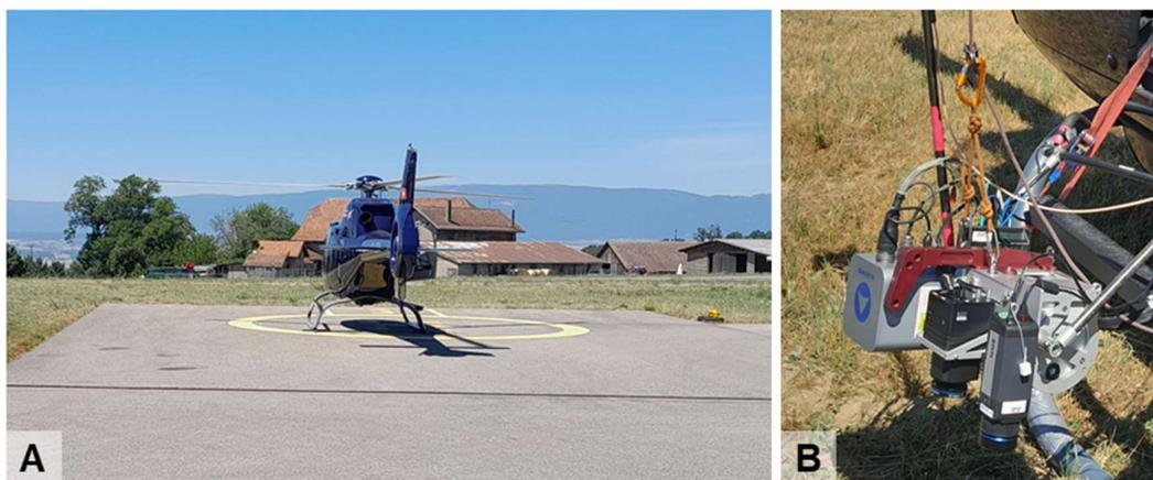
Figure 10. A) Eurocopter EC120 ayant servi au survol. B) Capteurs optique et thermique installés sur le côté de l'hélicoptère pour la prise de vue aéroportée. (Crédit : Helimap CH©).
