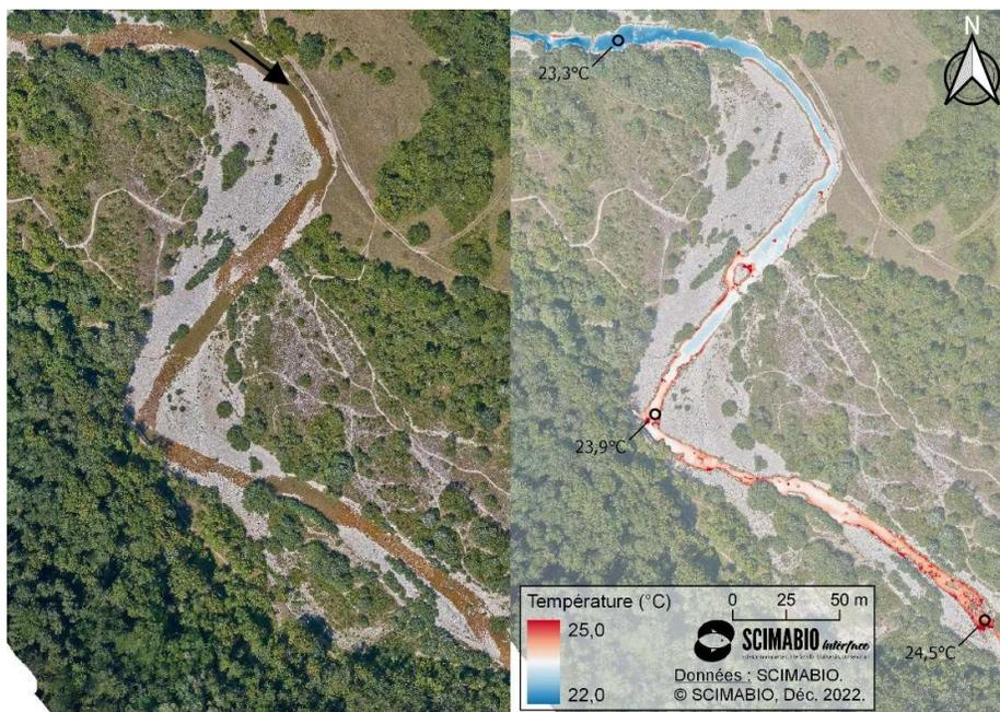
Figure 15. Orthophoto (à gauche) et mosaïque thermique (à droite) illustrant l'échauffement observé en amont des Feuilletières.
