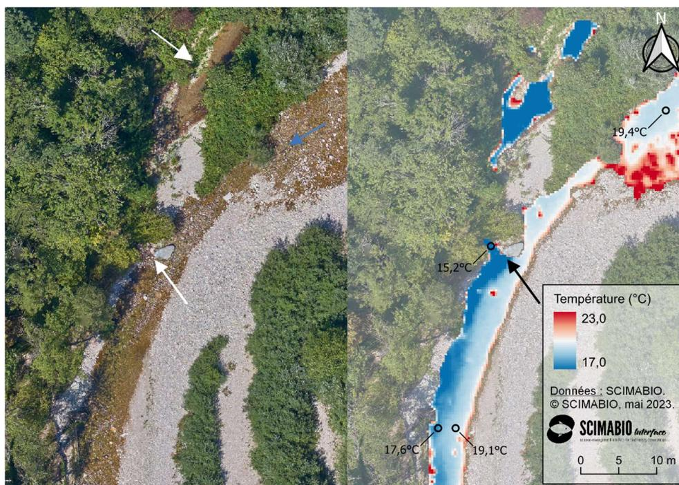
Figure 8. Orthophoto (gauche) et mosaïque thermique (droite) du panache en rive droite généré par un bras latéral au niveau du secteur de Crettaz. La flèche désigne l'emplacement de la sonde, tandis que le panache froid est visible depuis le bloc vers l'aval.
