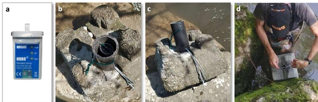
Figure 2. a) Thermographe HOBO Pendant® utilisé dans cette étude, b) installation d'un capteur dans son étui de protection PVC, c) arrimage du capteur et de son étui sur un bloc en béton et d) fixation de l'ensemble à la berge à l'aide d'un câble métallique (Photos SCIMABIO Interface®, 2021).
