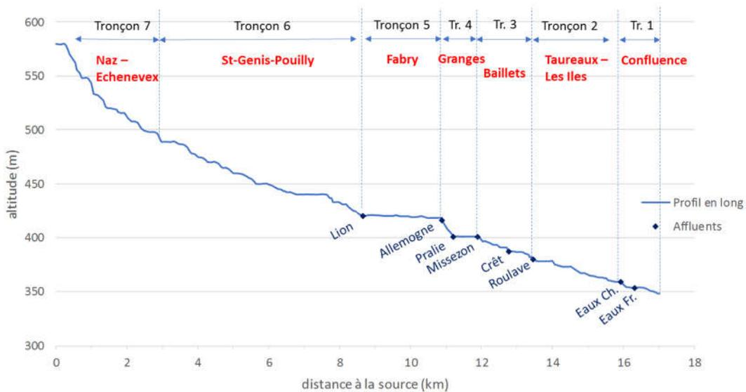
**Figure 2:** Profil longitudinal et sectorisation de l’Allondon
