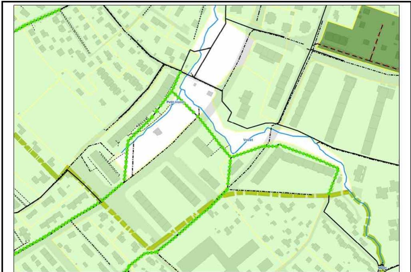
⇒ Chemisages sur le réseau EU (nombreuses fissurations, racines et défauts d'alignement), sur 830 mètres environ.
