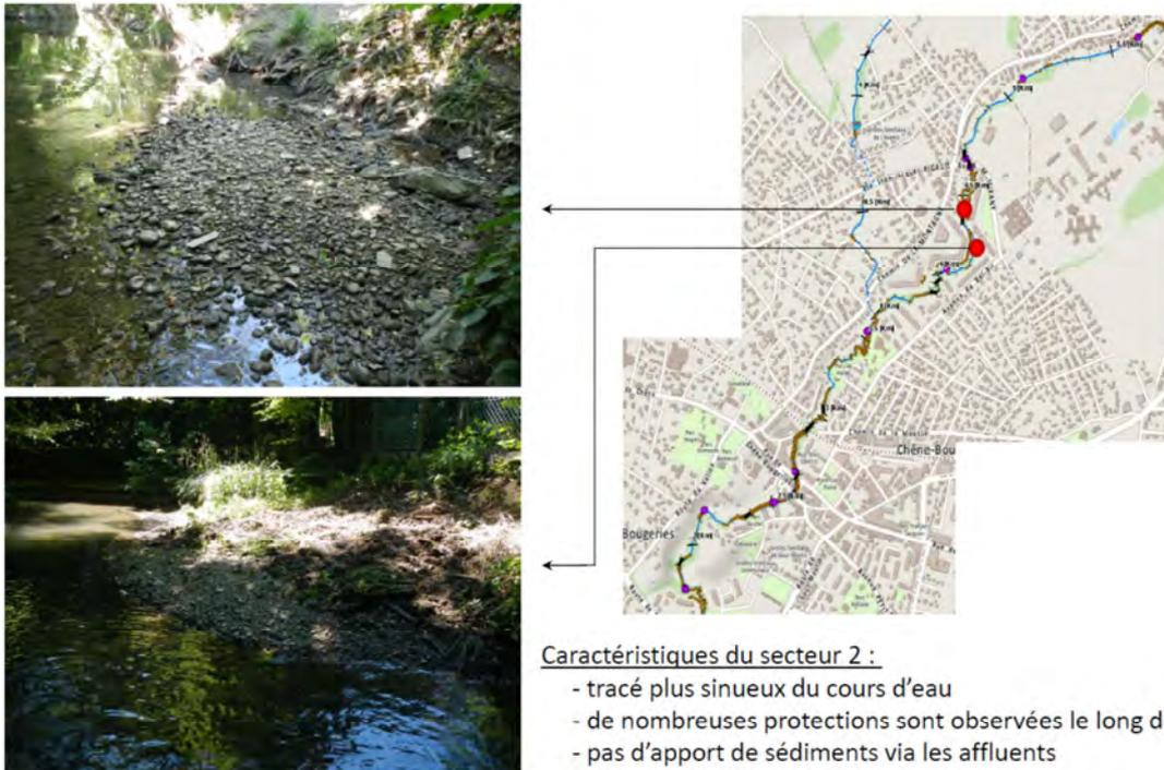
Figure 58. Bancs de graviers observés sur le secteur 2 de la Seymaz.
