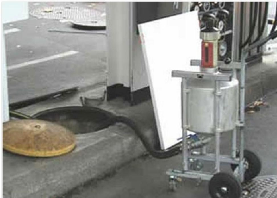
L'essence utilisée pour les essais est remise dans les différentes cuves. Puis lorsque tous les points contrôlés sont considérés comme conformes, la colonne inspectée est plombée officiellement avec les scellés du canton (GE+1) qui témoignent de l'exactitude métrologique de l'appareil de mesure.
