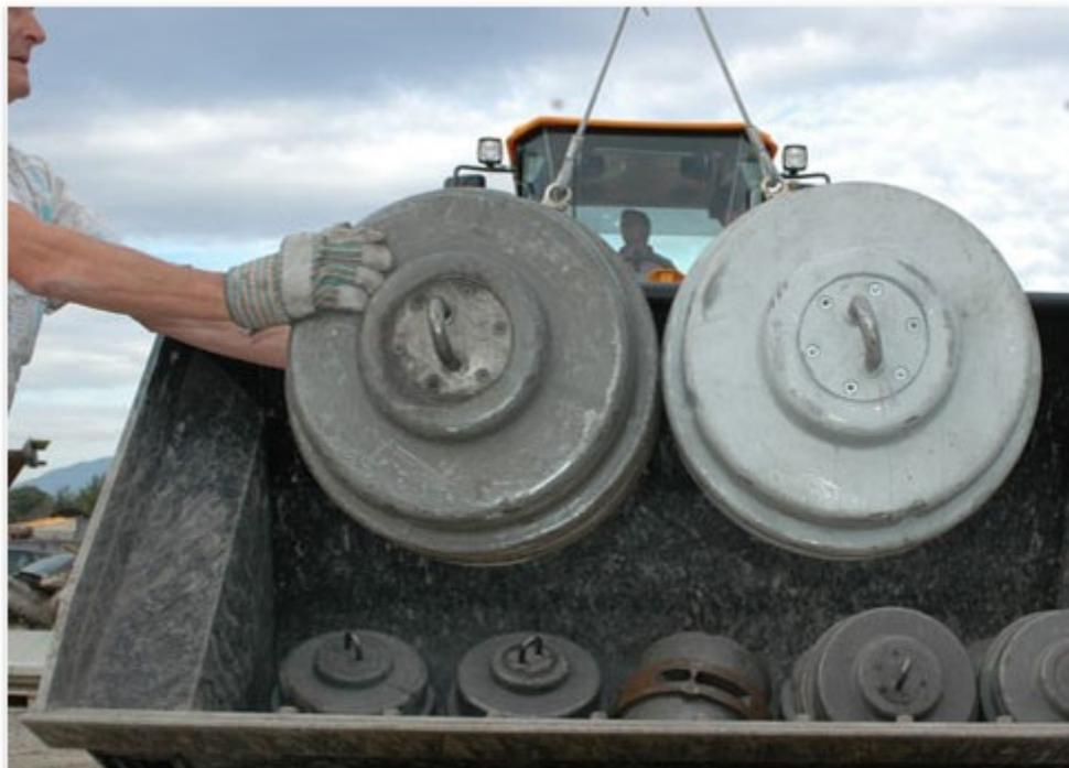
Dans l'exemple décrit ici, l'appareil de pesage dispose d'un échelon ("e") de vérification de 50 kg, la tolérance en service est de  $\pm 1$  e sur la moyenne de 5 pesées ou de  $\pm 2$  e sur une seule et unique pesée.
