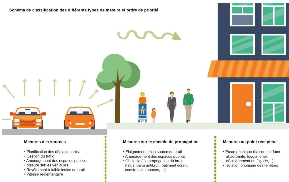
Figure 2 : Schéma de classification des différents types de mesure et ordre de priorité
