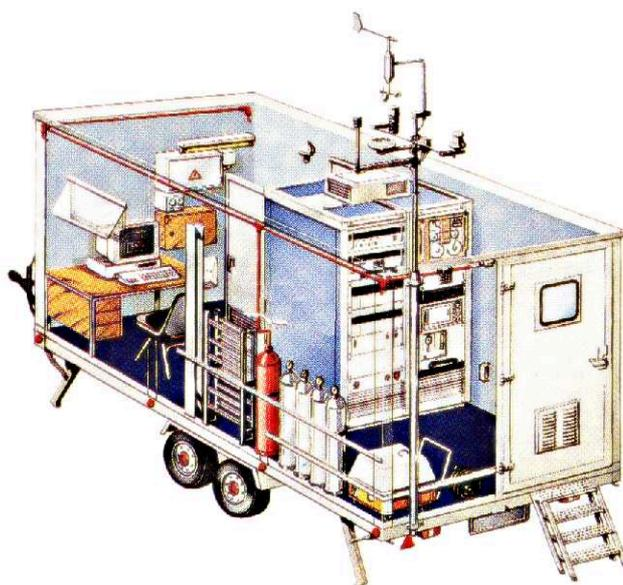
*Figure 1. Schéma en transparence d'une station mobile*
