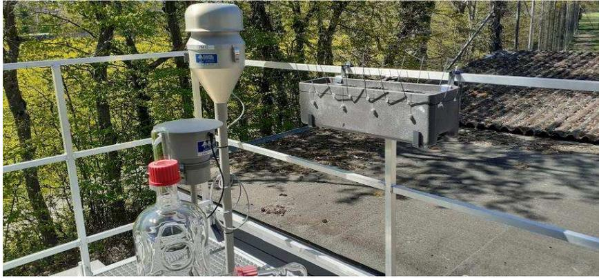
**Figure 19.** Bêcher de collecte d'aérosols sur le toit de la station de Bellevue
