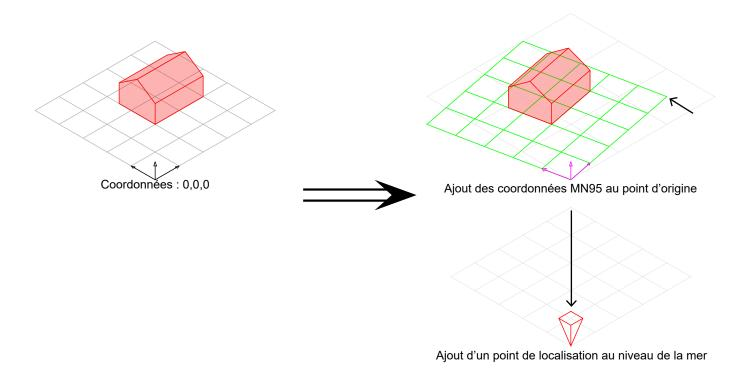
Le principe du géoréférencement d'une maquette BIM dans Archicad est le suivant :
