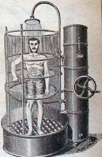
Appareils pour Douches à pression d'air: le n° 8, de 2<sup>m</sup>40 de hauteur sur 1<sup>m</sup>30 de longueur et 82 cent. de largeur, contenant 150 litres d'eau sous pression de 3 atmosphères, est composé de la douche en pluie, de 3 douches en cercles à 3 rangées de trous chaque cercle, d'une douche locale mobile avec 2 pommes d'arrosoir et lance à 2 jets à spatule, de la pompe à double effet et d'un manomètre. Son prix est de..... 550 fr.
