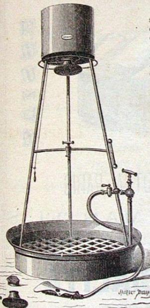
Appareil pour Douches à pression d'air n° 3, ayant 2<sup>m</sup>55 de hauteur sur 92 cent. de diamètre, contenant 40 litres d'eau sous pression de 3 atmosphères, composé de la douche en pluie et d'une douche en jet mobile avec 2 pommes d'arrosoir et lance à 2 jets à spatule. D'une pompe à manomètre 220 fr.
