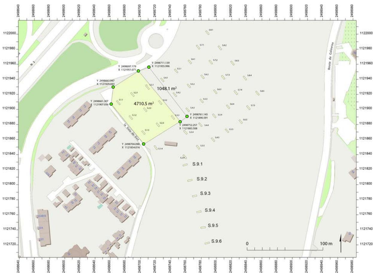
Fig. 2 Position des sondages dans la parcelle: les sondages cantonaux sont indiqués de S.9.1 à S.9.6.
