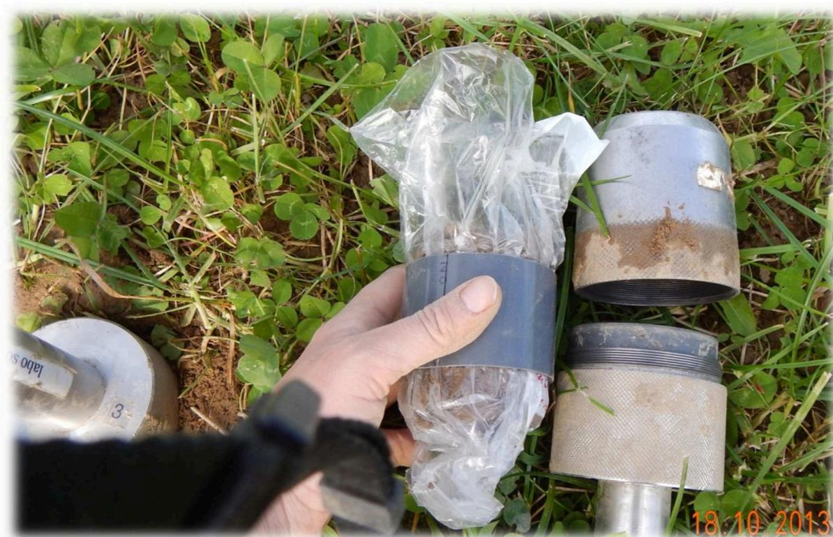
Figure 6 Ouverture du préleveur et contrôle de la qualité de l'échantillon
