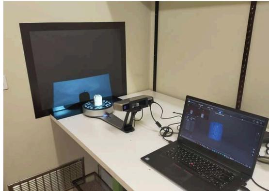
Figure 2 Scanner 3D de bureau et son installation
