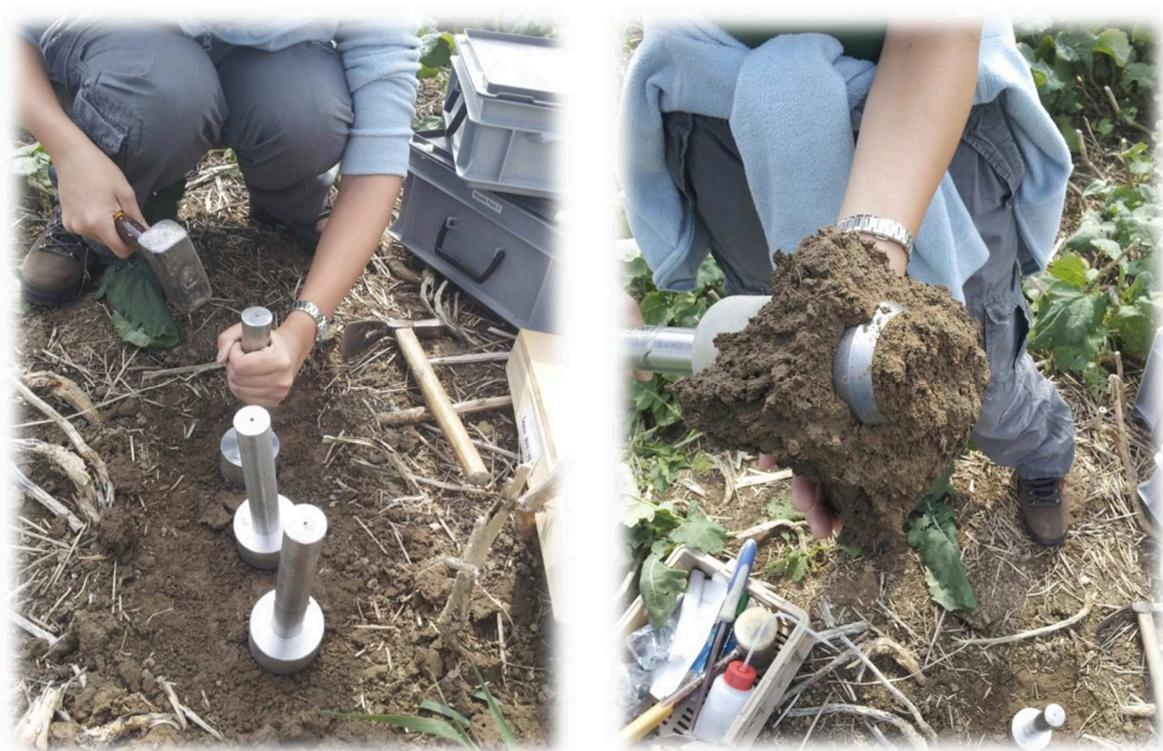
Figure 5 Prélèvement de l'échantillon de sol au moyen du préleveur HEPIA
