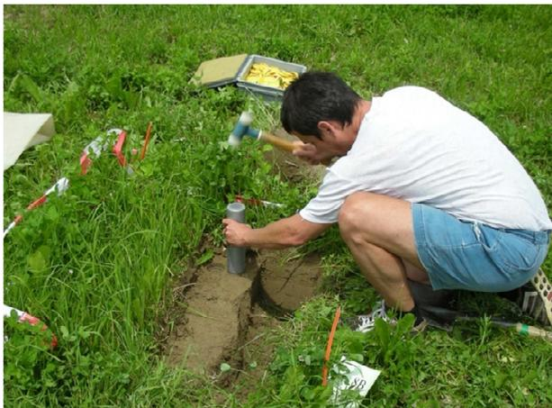
Figure 9 Prélèvement de cylindre de sol non remanié, enfoncement par percussion à l'aide d'un emporte-pièce.
