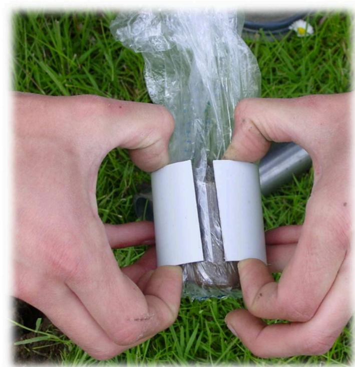
Figure 4 Cylindre de PVC fendu destiné à recueillir le sachet souple et l'échantillon de sol
