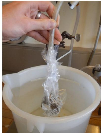
Figure 12 Mesure du volume par poussée d'Archimède
