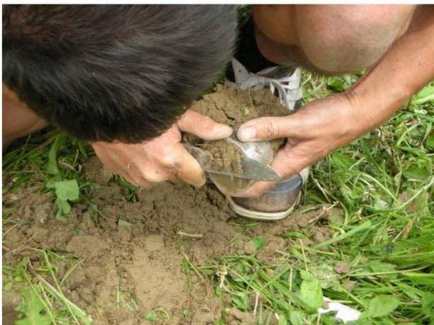
Figure 10 Prélèvement de cylindre de sol non remanié, recoupage du cylindre au droit des bords.
