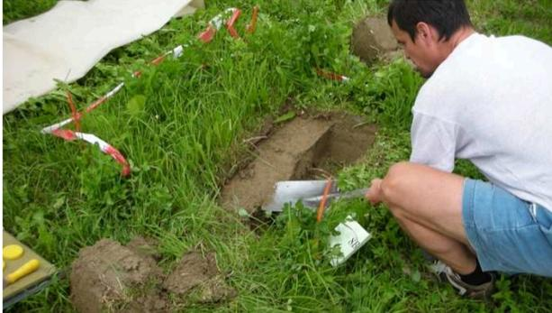
Figure 8 Prélèvement de cylindre de sol non remanié, réalisation d'un pré-trou.
