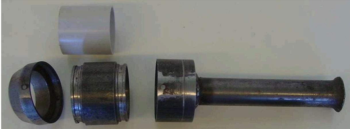
Figure 3 Différentes pièces du préleveur et cylindre de PVC interne
