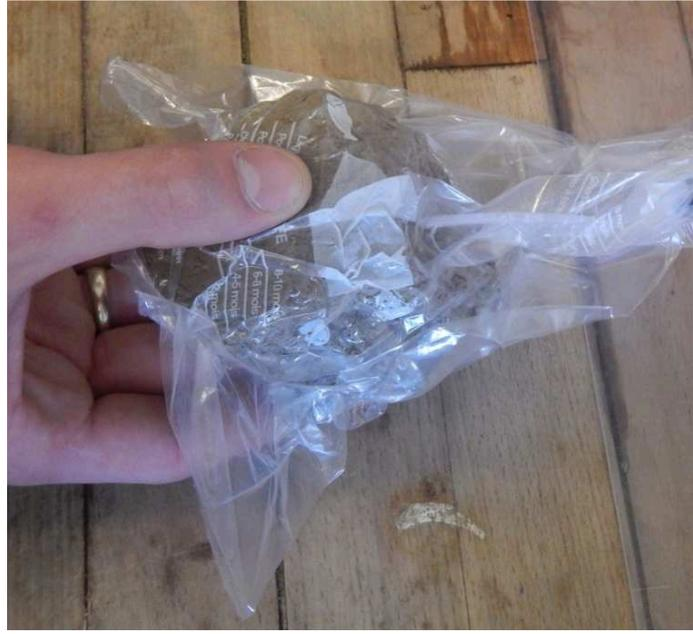
Figure 11 Insertion de l'échantillon dans le plastique et application d'un vide partiel (-400 à -600 hPa).
