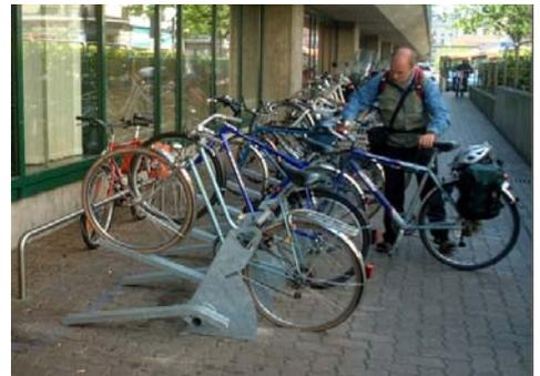
Fig. 5 Glissière avec dispositif de fixation du cadre, gare Cornavin
