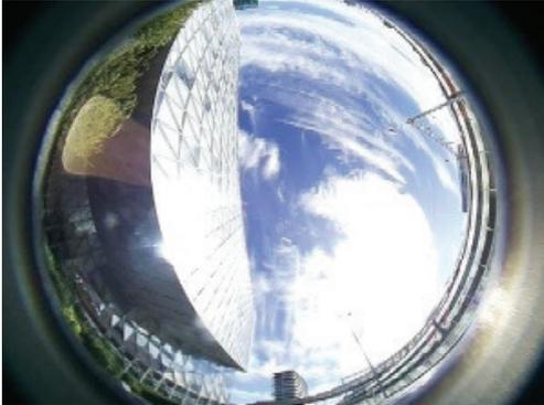
**Figure 28** – Photo du ciel, façade vitrée avec l'effet de double soleil
