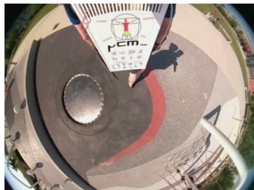
Figure 59 – Photo du sol, mesure de la température du sol revêtement: synthétique noir
