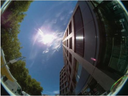
**Figure 36** – Photo du ciel, façade majoritairement vitrée, foncée mesure du rayonnement ambiant
