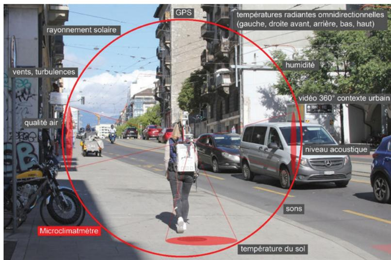
La présence d'un GPS sur le  $\mu$ CM permet de géolocaliser les mesures alors que deux caméras hémisphériques (2x 180°) enregistrent la scène *environnementale* réelle telle qu'elle se présente précisément au moment de chaque mesure. **Ceci permet une description et une compréhension sans ambiguïté de chaque valeur.** Ce dernier point fondamental distingue ultérieurement la rigueur de la méthodologie appliquée par le LEEA<sup>20</sup>.
