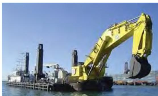
Figure 3 : Dragueur rétrocaveuse type
