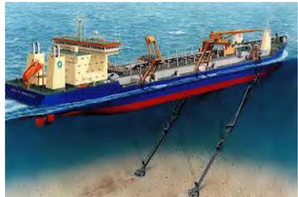
**Figure 4 : Drague suceuse type (tuyaux jumelés)**
