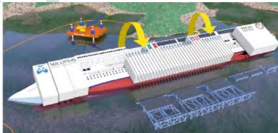
**Figure C2 : Images de l'installation des palplanches pour la récupération de la Costa Concordia**
