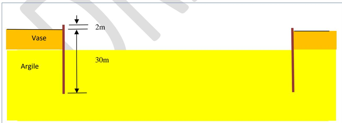
**Figure B6 : Dragage et élimination des argiles molles**
