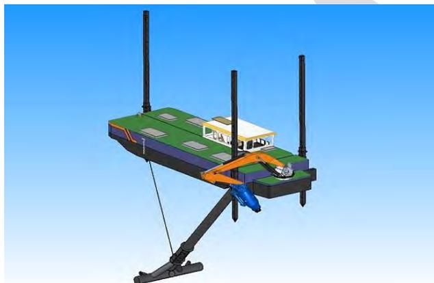
**Figure 5 : Drague hydrodynamique avec barre d'injection**
