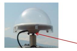
(h) = altitude mesurée à la base du support de l'antenne
