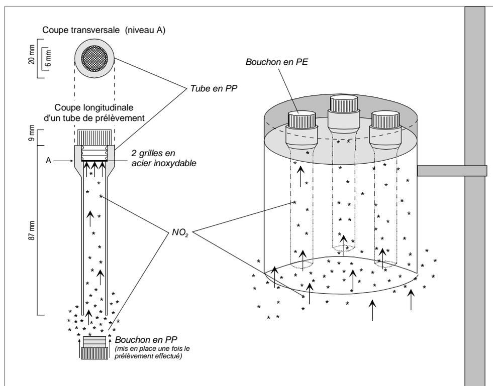
Figure 23. Principe de montage des capteurs passifs de NO<sub>2</sub>
