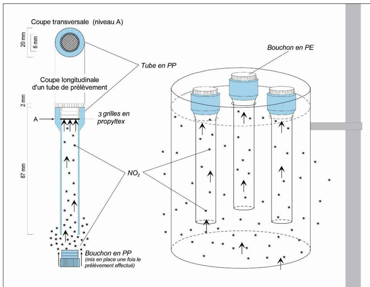
Figure 40. Principe de montage des capteurs passifs de NO<sub>2</sub>
