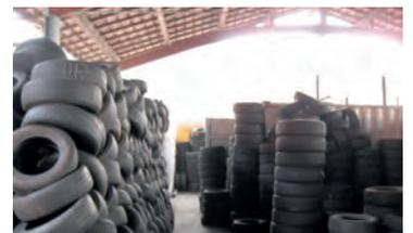
Les dépôts de pneus doivent toujours être équipés d'un sol en dur (revêtement étanche) et couverts dans la mesure du possible.
