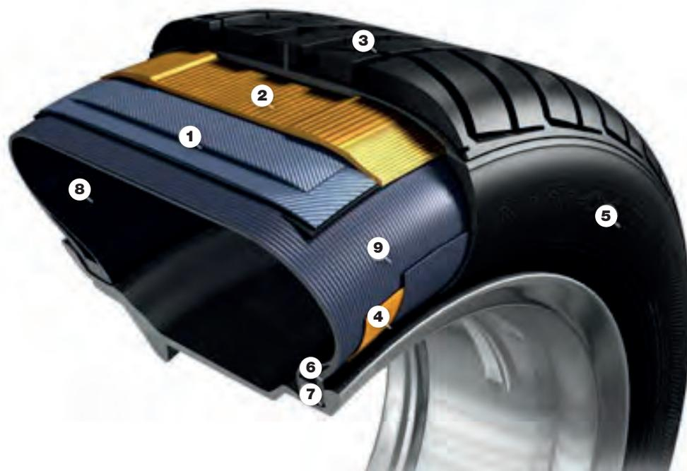
1 ceintures d'acier, 2 bandage, 3 bande de roulement, 4 nappe de renforcement, 5 flanc, 6 tringle, 7 talon, 8 gomme interne, 9 carcasse. Source: Reifen24.de
